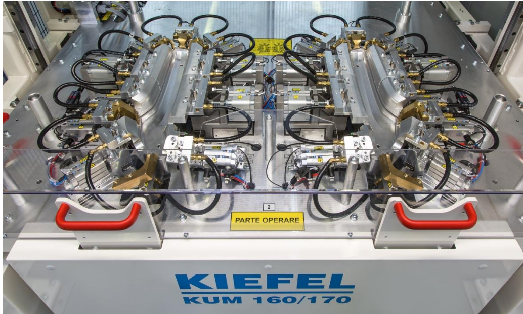
Umbugwerkzeug in Umbuganlage
